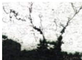
Beispiel für transkristalline Spannungsrissskorrosion an 1.4401 bei starker Chloridbelastung
